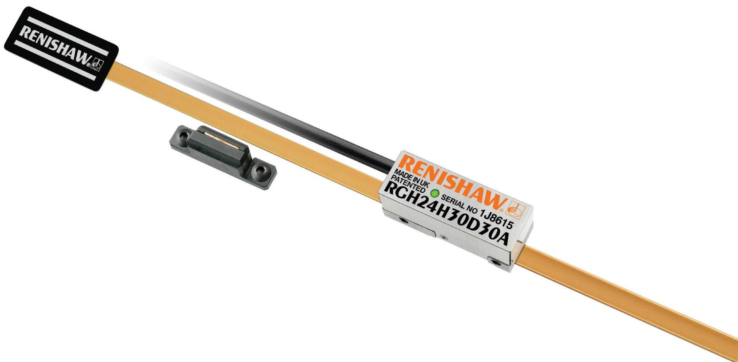
I sistemi Renishaw della serie RGH24 sono encoder ottici senza contatto. Il lettore include un indicatore LED che semplifica le operazioni di impostazione, è dotato di esclusive ottiche di filtraggio che lo proteggono dalla polvere e di un'interpolazione integrata fino a soli 10 nm. L'assoluta affidabilità di RGH24 rappresenta un valore aggiunto in termini di prestazioni e rapporto qualità prezzo, motivo per il quale è diventato uno degli encoder più diffusi al mondo.
