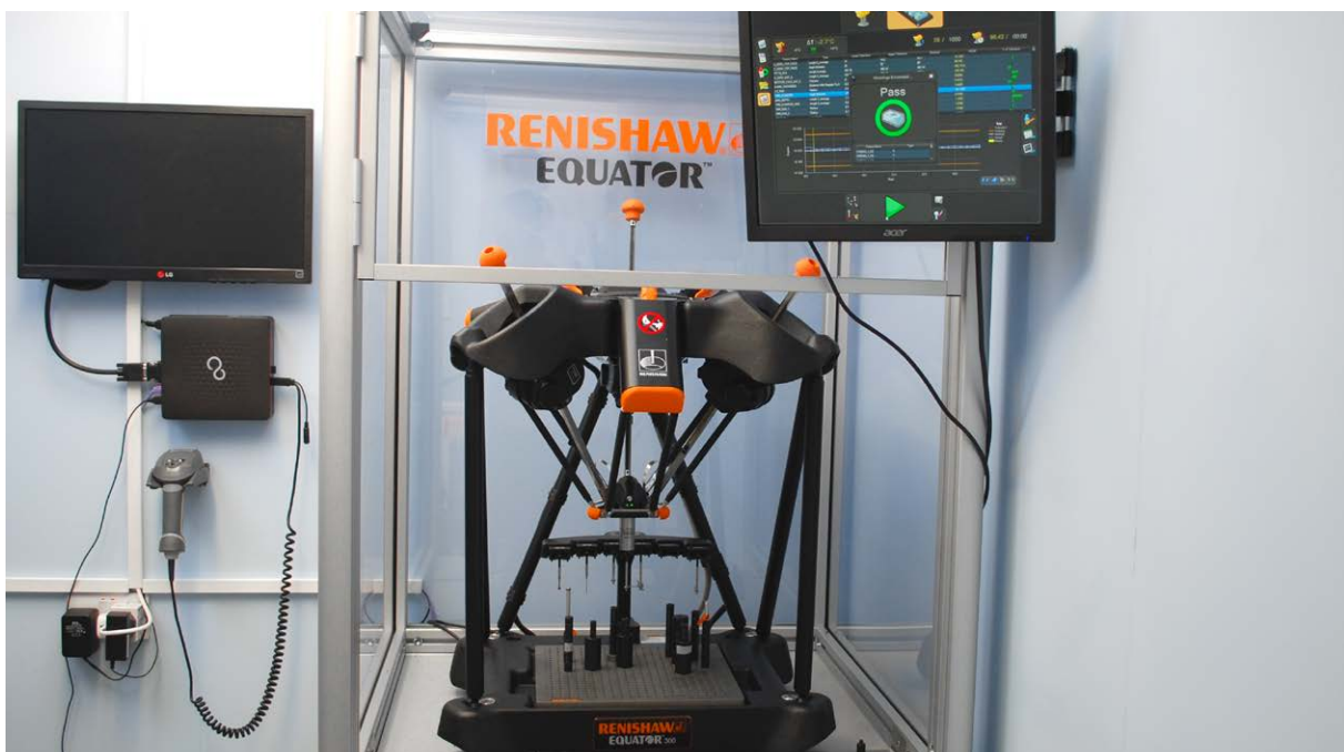
Hệ thống đo đặc và kiểm tra Equator của Renishaw tại High-Tech engineering
