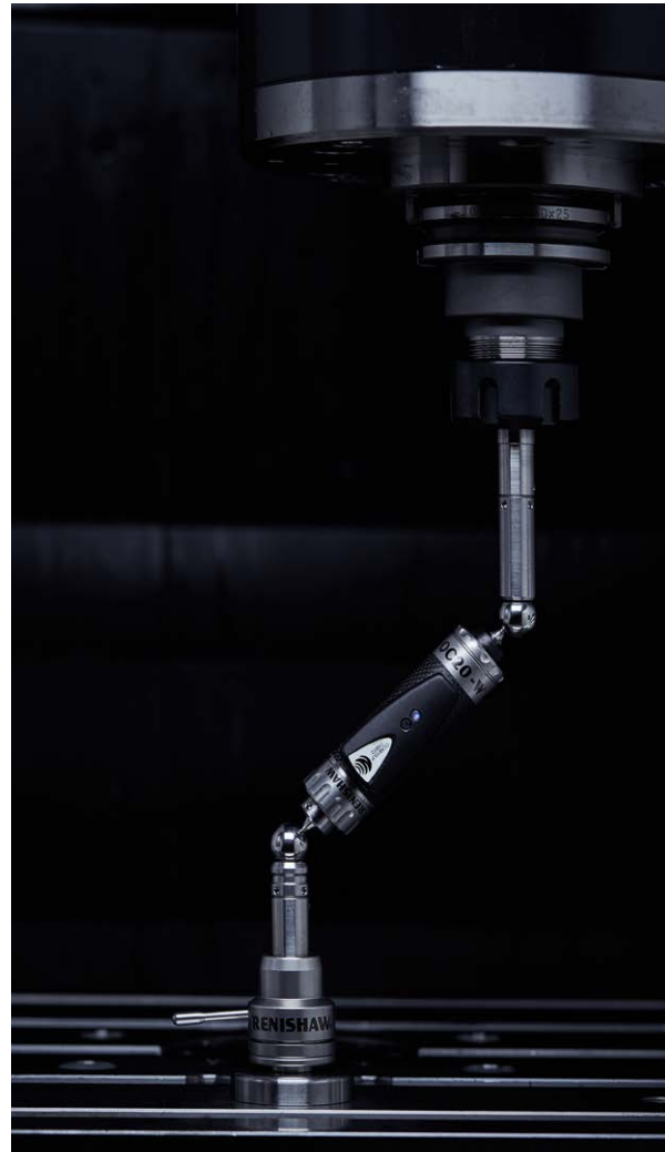
Ballbar QC20-W sistema en una máquina CNC
