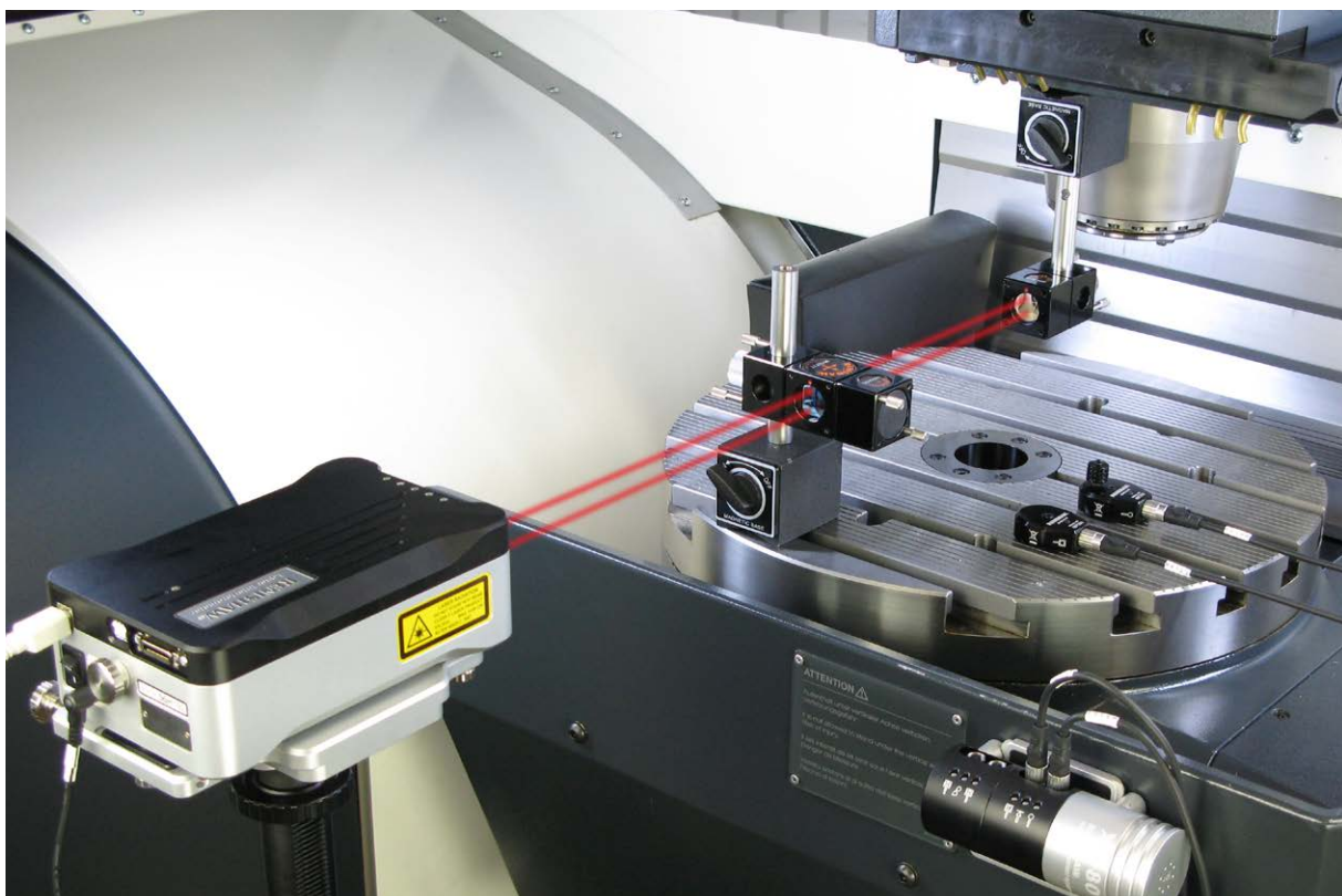
Calibración láser con el sistema de interferómetro láser un contrato de mantenimiento con Renishaw XL-80
