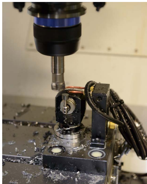
Sonda di presetting utensili RTS
