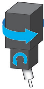
ISO 10791-6测试项 = 'AK' 摆头 - 摆头机床 2个回转轴位于主轴头上
