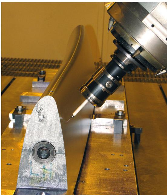
特許取得済 RENGAGE 技術により、一回のキャリブレーションで、あらゆる方向からのプローブ計測が可能。パーツの輪郭に注意してください。計測ルーチンは OMV Pro ソフトウェアによりオフラインでプログラミングし、Siemens 840D CNC 上で実行して、PC 上でオフラインにより結果を評価します。
