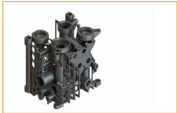
二次迭代几何形状。移除模块取出通道，重新加工支撑结构，增加其刚性和硬度
