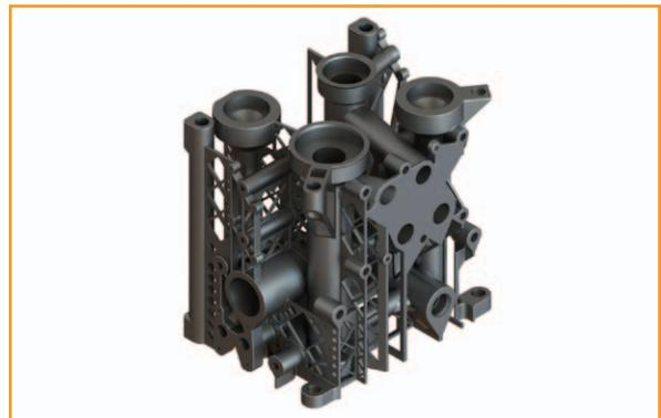
首次迭代几何形状。将流动通道取出，进行优化并设置壁厚。支撑结构用于固定流动通道并连接固定位置
