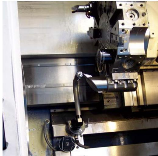
Réglage des arêtes de coupe de l'outil muni d'un bras de précision Renishaw amovible
