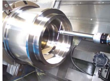
Palpeur sur tourelle d'un tour CN, économisant jusqu'à 80% sur la durée des contrôles des caractéristiques critiques
