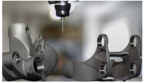
生产钛合金部件的最后一步是使用雷尼绍测头进行检测。
