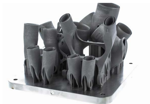
一部车架中使用的全部钛合金管托可在雷尼绍增材制造系统的加工托盘上一次加工完成。
