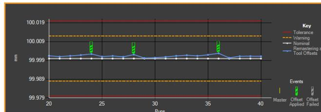
Process Monitor 畫面範例顯示刀具磨耗造成的偏移，透過 IPC 進行修正
