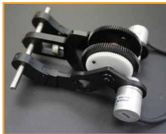
RE22磁旋转编码器在反馈装置上的应用
