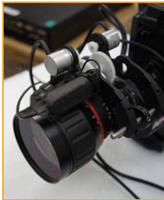
摄像头对焦及变焦位置反馈装置
