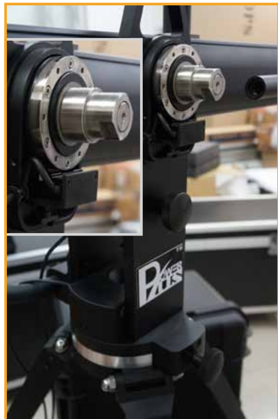
RESR圆光栅系统在虚拟摇臂上的应用
