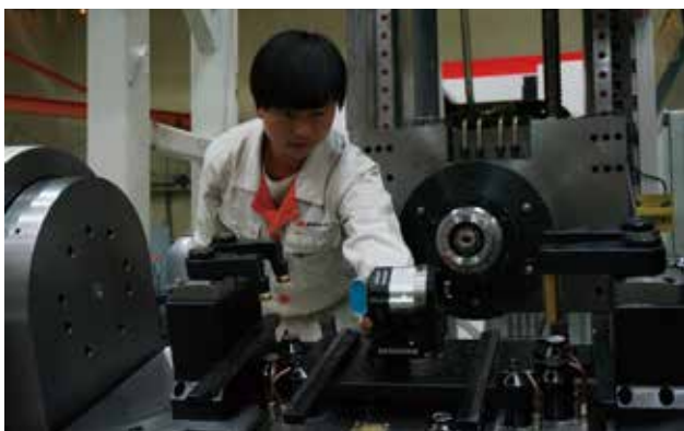
雷尼绍XR20-W回转轴校准装置
