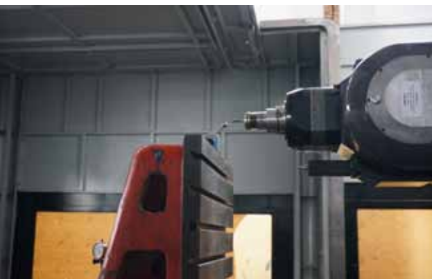
雷尼绍AxiSet Check-Up回转轴心线检查工具
