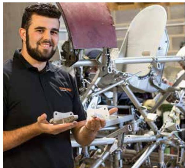
雷尼绍在自己的AM250增材制造系统上使用铝粉生产金属支架，整个部件通过四次加工过程完成。
