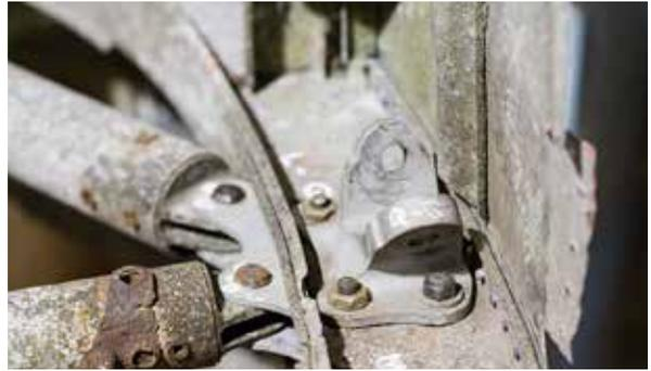
“喷气时代”航空博物馆请求雷尼绍帮忙重新制造霍克台风战斗机身上的两个支架——这类支架在同类战机中极为少见。
