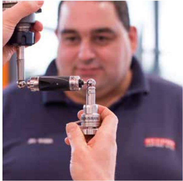
BAE Systems员工Jim Walsh正在使用雷尼绍QC20-W球杆仪
