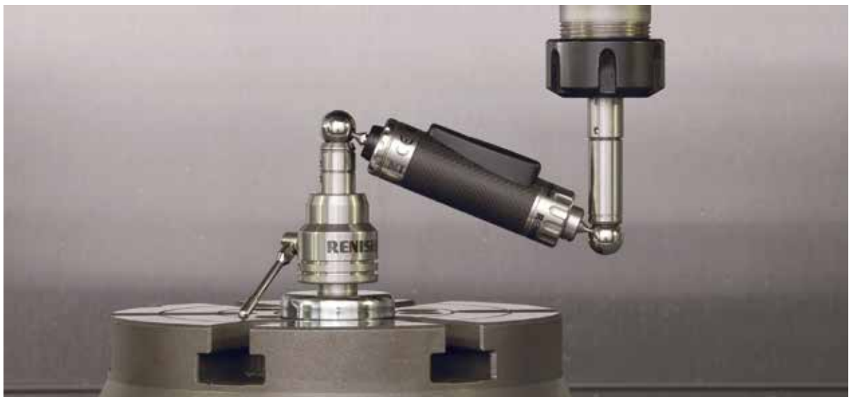
用于机床性能诊断的雷尼绍QC20-W无线球杆仪
