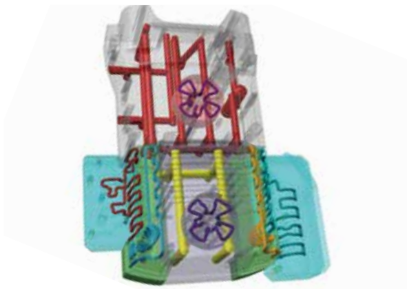
K2黄色后壳生产模具的全新设计，具有随形冷却功能
