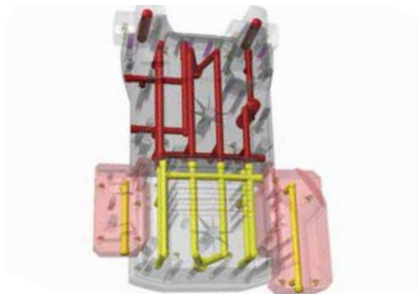
K2黄色后壳生产模具的原始设计
