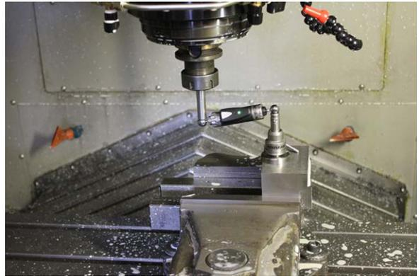
QC20无线球杆仪对Aquasub的机床执行测试
