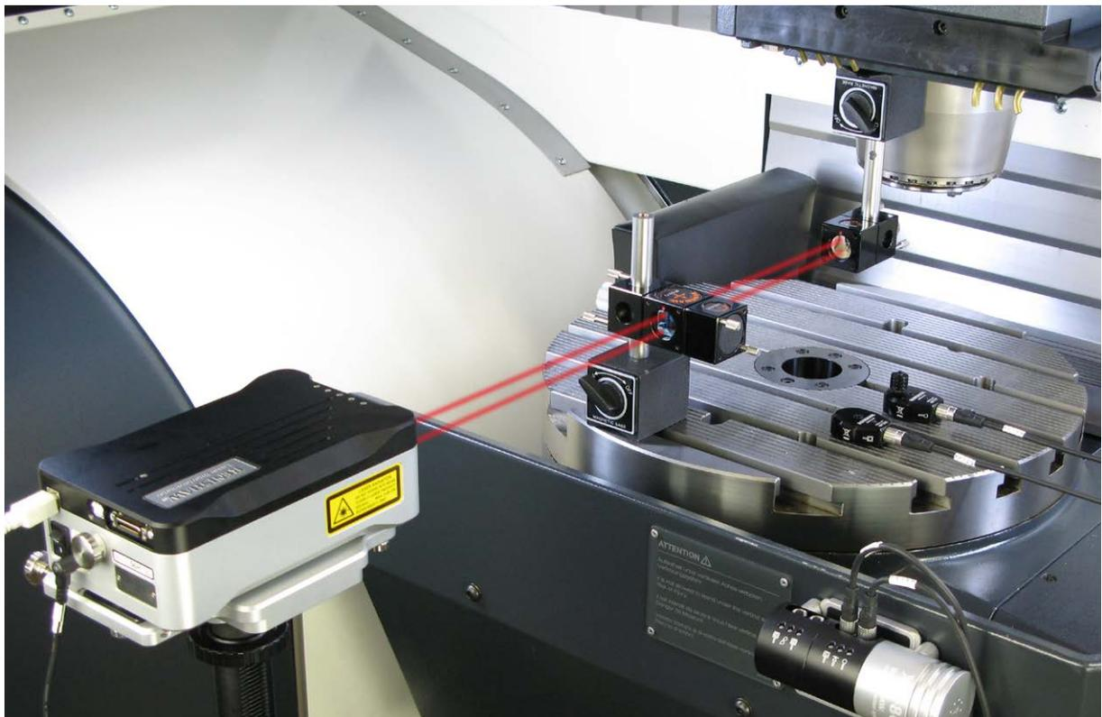
雷尼绍XL-80激光干涉仪正在执行激光校准
