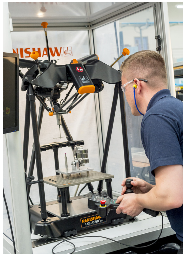
System Equator kontroluje część lotniczą
