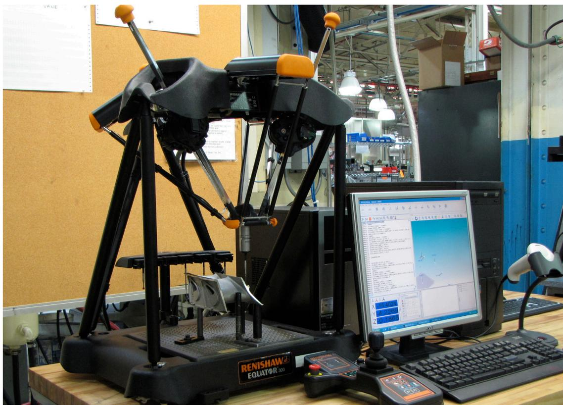
*Equator ersetzt mehrere zweckgebundene Messvorrichtungen und wird durch einfache Programmierung neu konfiguriert*
