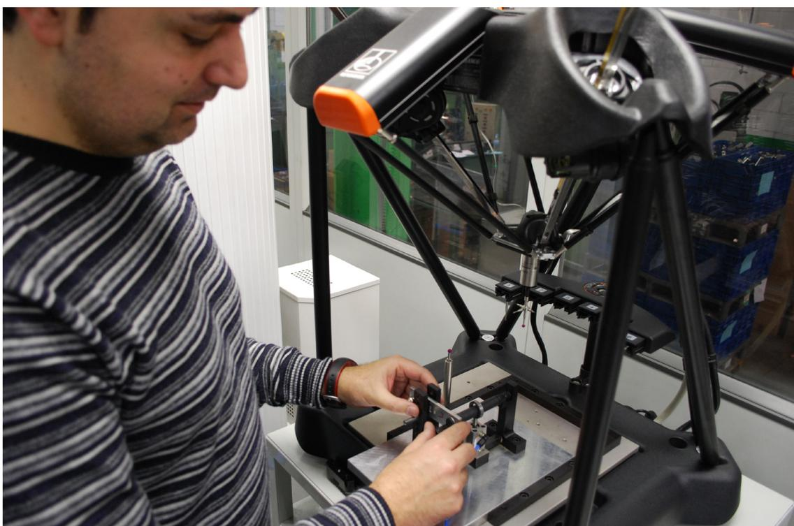
*Ein Eponsa Techniker lädt ein Teil eines Wischermechanismus auf das Equator Prüfgerät*
