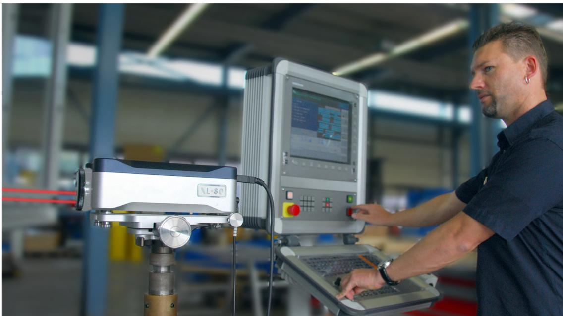
*Das XL-80 ist schneller und einfacher aufgebaut, wodurch die Prüfzeiten verkürzt werden*
