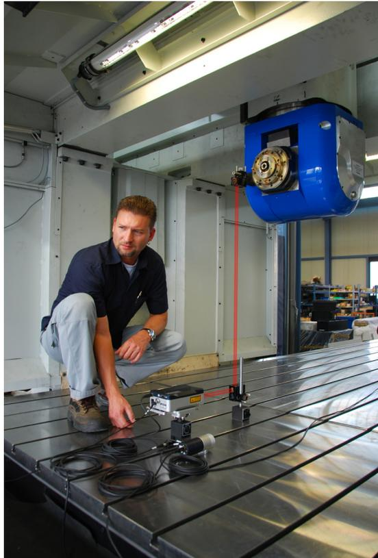
*Das kompakte XL-80 ermöglicht Jürgen Emslander die Überprüfung der Genauigkeit in mehr Positionen; auch im Inneren einer Maschine wie dieser von Edel*
