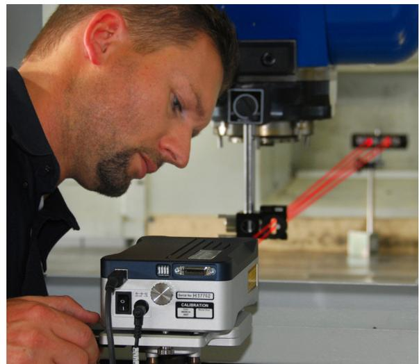
*„Der Aufbau des XL-80 Systems ist durch die oben angebrachten LEDs unkompliziert; wir können die Signalstärke im Auge behalten, ohne ständig zum PC laufen zu müssen“, so Jürgen Emslander*
