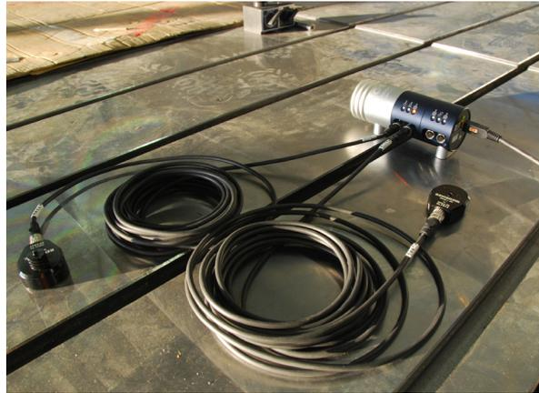
*Sensoren, die an die XC-80 Kompensationseinheit angeschlossen sind, messen die Temperatur und den Luftdruck, und ermöglichen den Einsatz unter allen Bedingungen*
