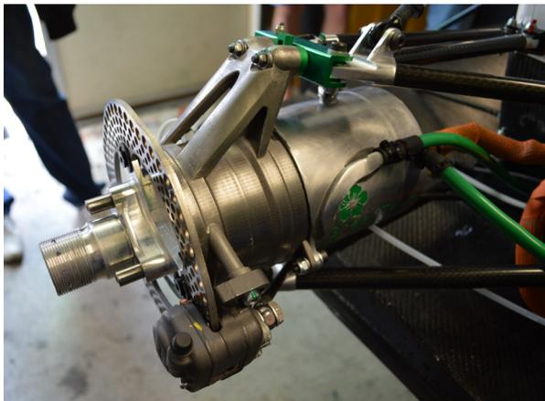
Durch optimierte Radträger aus Titanlegierung, die mit Renishaws generativem Fertigungsverfahren hergestellt wurden, konnten 1,5 kg des Fahrzeuggesamtgewichts eingespart werden.
