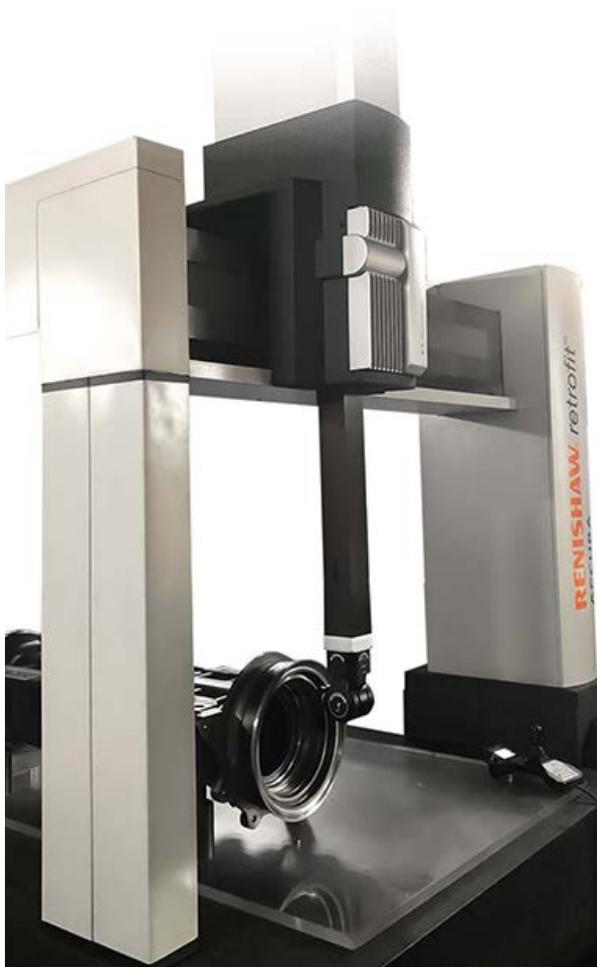
REVO bei der Messung eines Kanonenrohrs für den Einsatz in der Lokomotivindustrie
