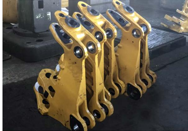
Schwenkrahmenkomponenten zum Einsatz in der Baubranche
