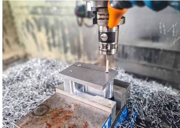
Werkstückeinrichtung und -prüfung mit Renishaws OMP40-2 Messtaster mit optischer Signalübertragung
