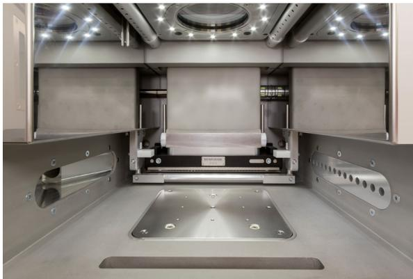
Baukammer, generatives Fertigungssystem auf Metallbasis RenAM 500M
