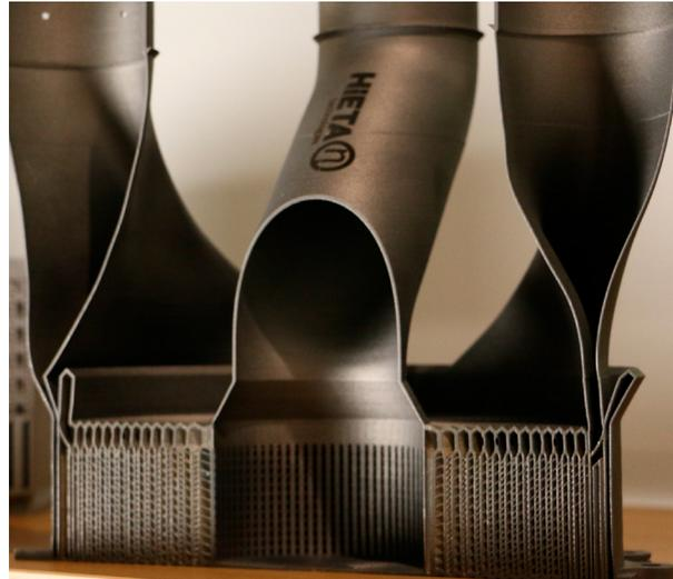
Querschnitt des SLAMMiT Wärmerückgewinnungssystems
