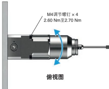
3. 将测针调整到所需的设置后, 检查全部4个调节螺钉是否均以2.60 Nm至2.70 Nm的扭矩紧固。
