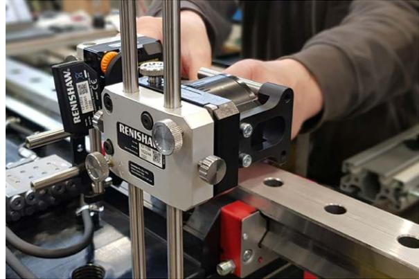
Alineación del pentaprisma del sistema XK10 para la realización de un ensayo de paralelismo
