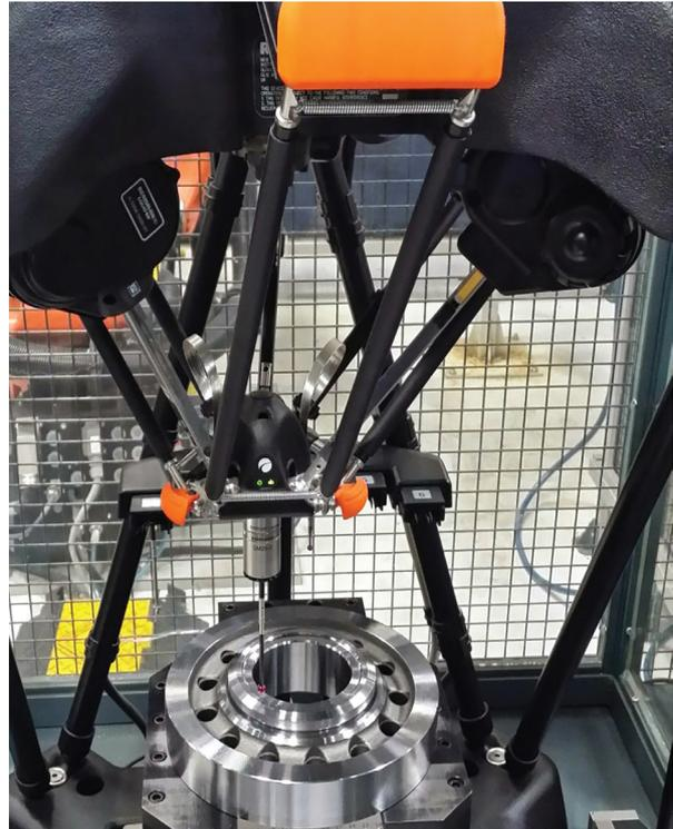
Con el sistema Equator, Tremec puede verificar fácilmente todas las cotas controladas de los engranajes en el taller. La inspección tarda dos minutos y medio, sin necesidad de medir algunas cotas en la sala de control de calidad, donde se tardaba aproximadamente 20 minutos de promedio, más el tiempo de estabilización térmica de la pieza en la sala.
