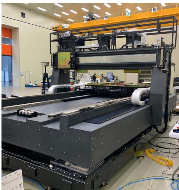
Plataforma para inspección óptica automática (AOI) de paneles de pantalla plana (FPD)
