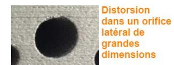
Les orifices et les tubes dont le diamètre est supérieur à 10 mm nécessitent un support central et devraient faire l'objet d'une reconception. Les orifices dont la taille est comprise dans cet intervalle peuvent être produits sans supports, mais ils subiront probablement une distorsion sur leurs surfaces de peau inférieure en raison d'un refroidissement lent du bain de fusion au-dessus du porte-à-faux.
