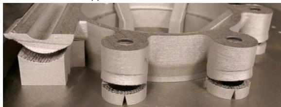
Dans certains cas plus extrêmes, la contrainte peut dépasser la résistance de la pièce et conduire à une rupture catastrophique du composant ou à une distorsion du plateau de fabrication.
