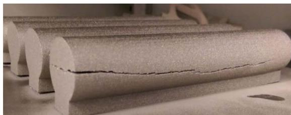
Ces effets sont plus prononcés dans les pièces ayant des sections élevées, car celles-ci ont tendance à avoir des pistes de soudure plus longues avec davantage de distance pour l'action des forces de cisaillement.
