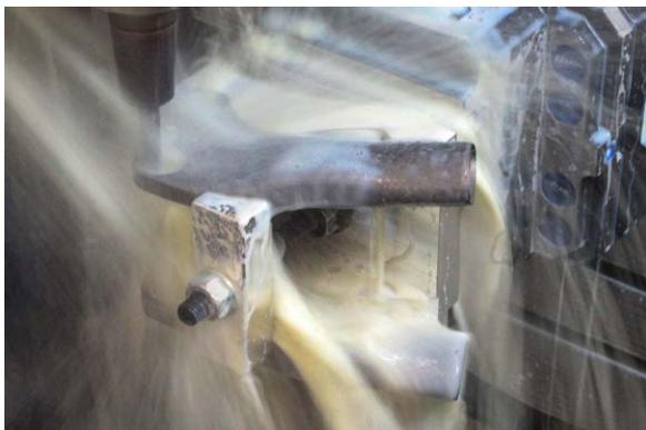
Mecanizado del 'yoke' (alargador del amortiguador): un componente crucial de la suspensión trasera. El mecanizado de precisión de los orificios de soporte se realiza en un centro de mecanizado de 5 ejes, donde se inspecciona para definir los datos de información y controlar el desgaste de herramienta para cumplir las tolerancias exigidas.
