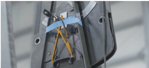
安装在锤头（控制翼面内部水平架板）上的编码器
