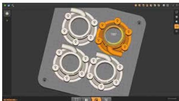
QuantAM软件中的路虎BAR帆船演示金属增材制造岐管
