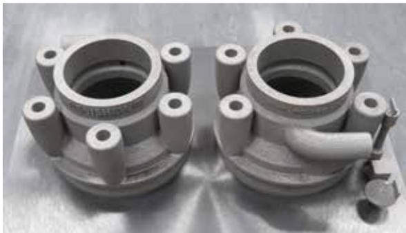
加工托盘上的路虎BAR帆船演示金属增材制造歧管
