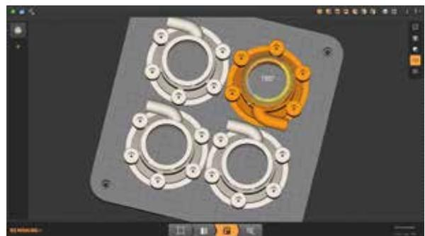
QuantAM软件中的路虎BAR帆船演示金属增材制造歧管
