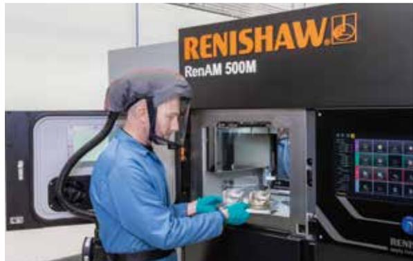
从雷尼绍RenAM 500M金属增材制造系统中取出路虎BAR帆船演示金属增材制造歧管
