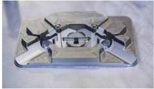
使用雷尼绍触发式工件测头可轻松找正复杂模具的位置。
