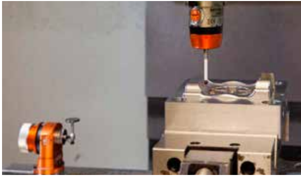
包含Primo Radio Part Setter（工件测头）和Primo Radio 3D Tool Setter（3D对刀仪）的雷尼绍Primo系统，通过缩短设定时间显著提高BK Tooling的生产效率。
