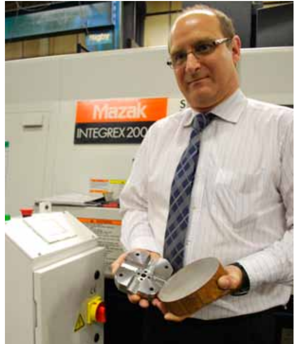
Steve Randerson双手分别拿着坯料和在Mazak Integrex上生产的成品工件
