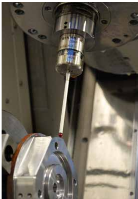
Mazak Integrex多轴车铣中心的主轴上配备雷尼绍OMP400测头
