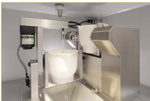
*Interno della camera superiore della macchina 5/01 V Renishaw per stampi sotto vuoto*
