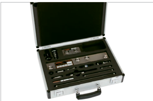
QC20-W Kreisformtest mit Zerodur® Kalibriereinheit
