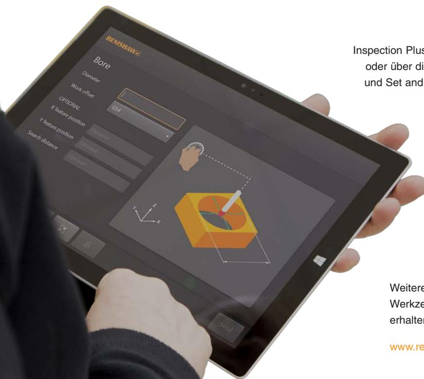
Inspection Plus kann manuell mittels G-Code oder über die Programmier-Apps GoProbe und Set and Inspect programmiert werden.
