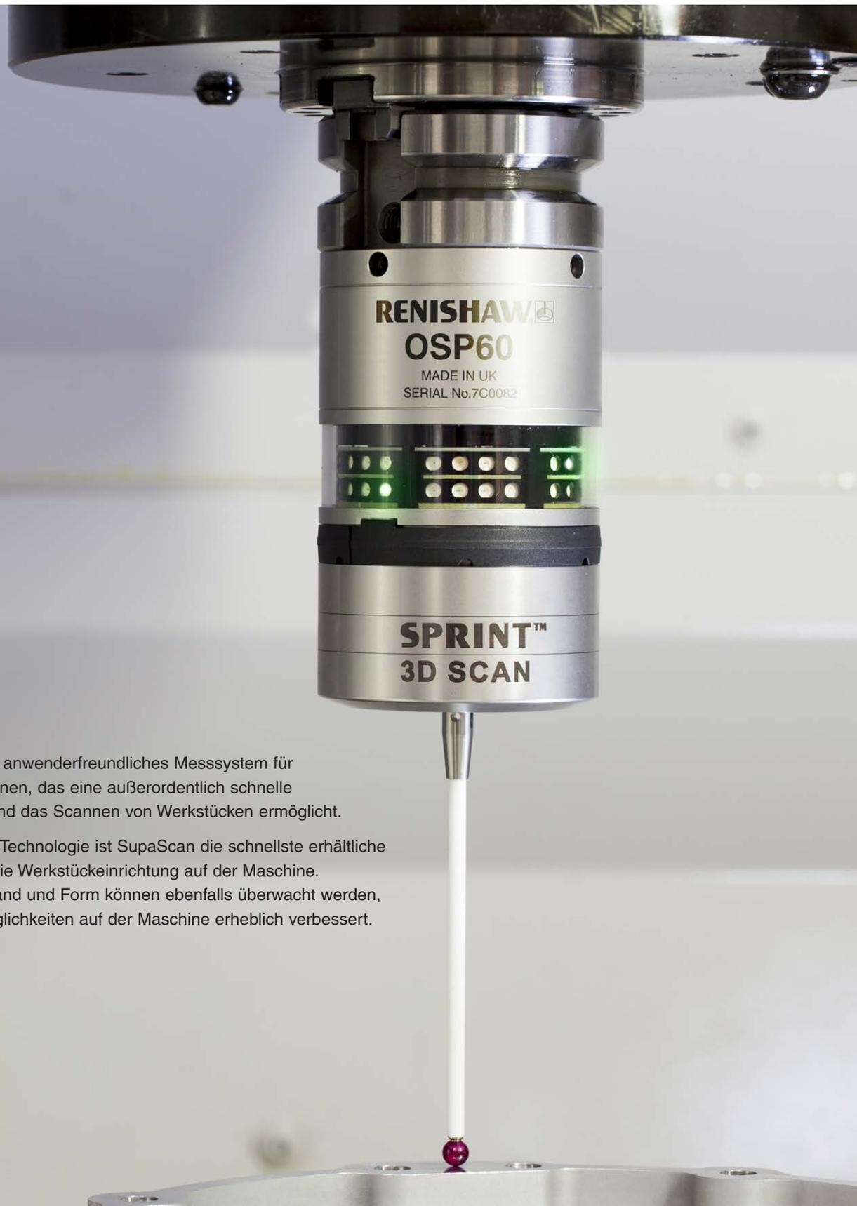
SupaScan ist ein anwenderfreundliches Messsystem für Werkzeugmaschinen, das eine außerordentlich schnelle Punktmessung und das Scannen von Werkstücken ermöglicht.
