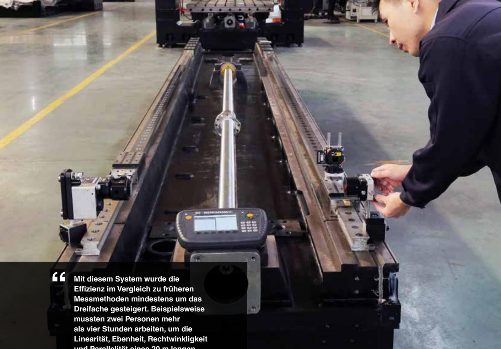
“ Mit diesem System wurde die Effizienz im Vergleich zu früheren Messmethoden mindestens um das Dreifache gesteigert. Beispielsweise mussten zwei Personen mehr als vier Stunden arbeiten, um die Linearität, Ebenheit, Rechtwinkligkeit und Parallelität eines 20 m langen Bearbeitungszentrums in Gantry-Bauweise zu messen. Seit wir das XK10 System verwenden, kann eine Person die Messungen in weniger als zwei Stunden abschließen.
