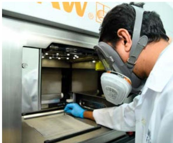
La camera di lavorazione del sistema AM di Renishaw
