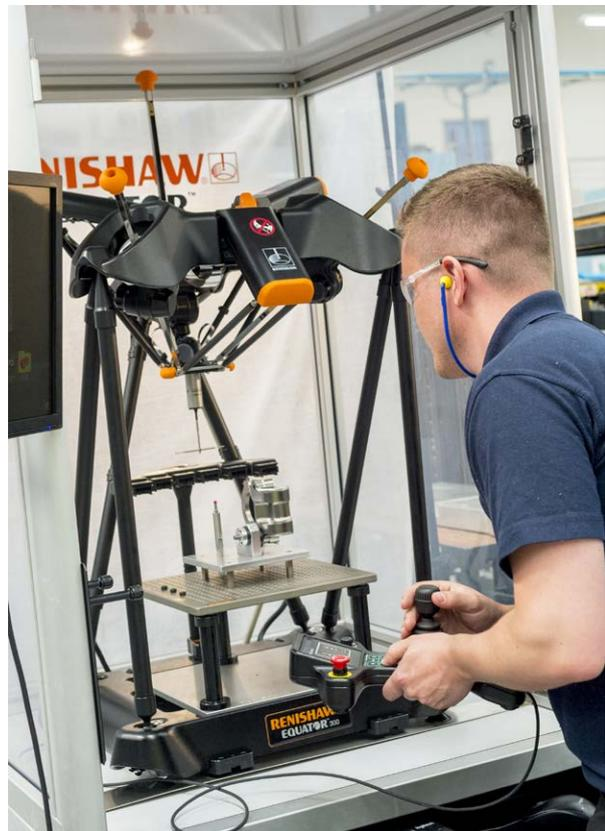
Equator durante l'ispezione programmata di un componente per il settore aerospaziale
