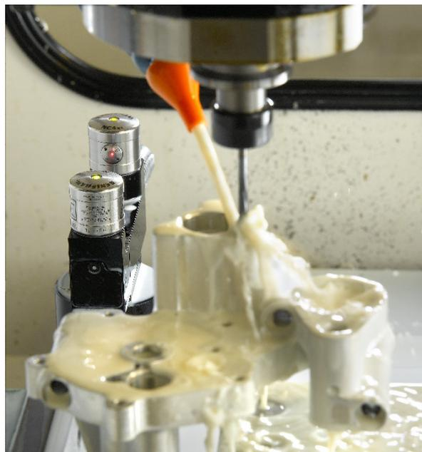
*Il sistema NC4 di Renishaw è utilizzato per evitare che una rottura utensili possa danneggiare componenti particolarmente costosi – eliminando scarti, rilavorazioni e tempi di inattività.*
