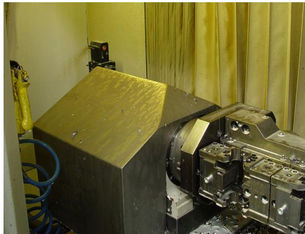
*Il sistema laser senza contatto di Renishaw montato all'esterno del campo operativo della macchina*
