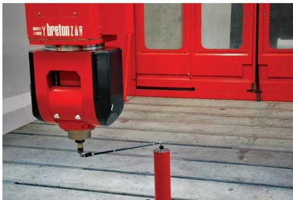
Breton utilizza il ballbar QC20-W di Renishaw per verificare l'accuratezza di posizionamento degli assi delle macchine
