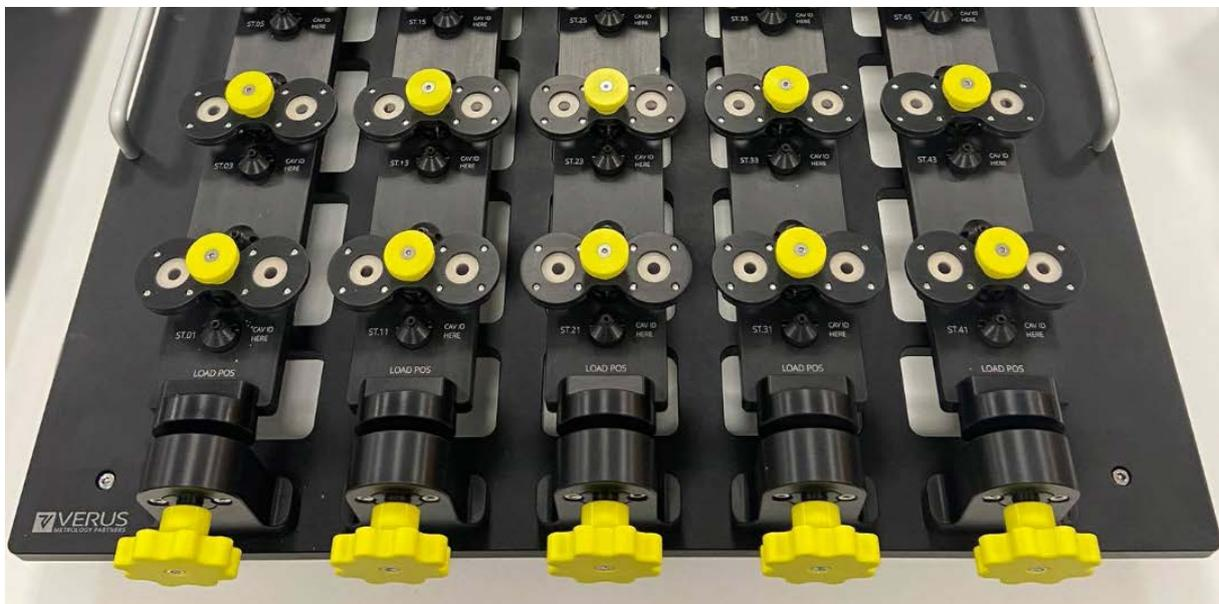
Sistema di fissaggio Verus a 48 stazioni realizzato ad hoc per l'ispezione di componenti in gomma morbida
