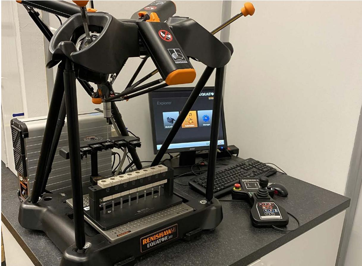
Una delle soluzioni di fissaggio per tubetti e cappucci progettate da Verus Metrology per l'ispezione su Equator™ 300
