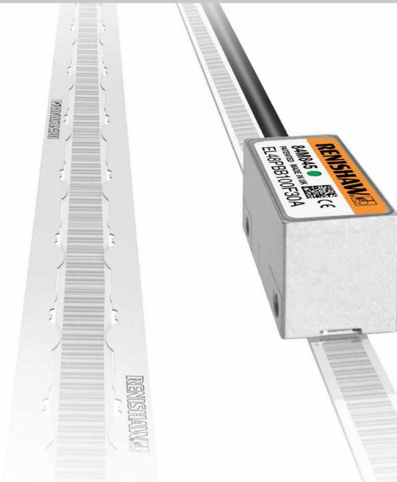
Das auf derselben industrieerprobten Technik wie RESOLUTE™ beruhende System EVOLUTE ist ein absolutes, berührungsloses, optisches Messsystem mit 50 µm Teilungsperiode, das verbesserte Installationstoleranzen sowie eine höhere Unempfindlichkeit gegenüber Verschmutzungen für Großserienanwendungen bietet, die höchste Funktionssicherheit verlangen.
