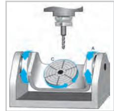
AxiSet Check-Up unterstützt, durch die Bereitstellung von schnellen und präzisen Diagnosen von Rotationsachsen-Drehpunkten, den Aufbau der Prozessgrundlage durch eine Maximierung der Stabilität von Umgebung und Maschine.
