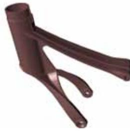
1. 针对铝合金铸造工艺设计的座管CAD模型
