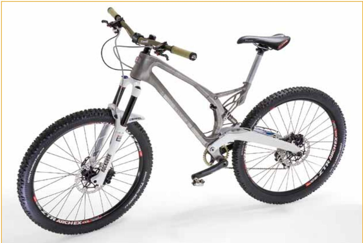
配备了3D打印钛合金车架和座管支架的完整自行车
