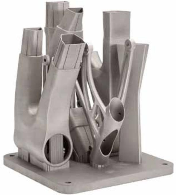
整个自行车架分为几部分，连同座管支架在一个成型托盘上一次性打印制成
