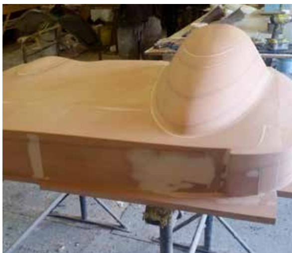
加工后的16块模型板必须精确地装配在一起，这样才可确保最后的玻璃纤维顶盖形状符合要求，所需要的手工修整打磨的工作量最小
