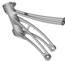
3. Reprojetado pela Empire Cycles utilizando como modelo o modelo CAD otimizado
