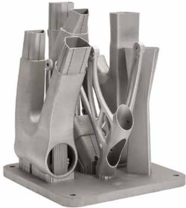
O quadro inteiro da bicicleta foi disposto em seções, com o suporte do selim em uma placa de construção, sendo fabricado em uma só operação
