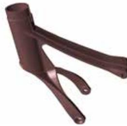
1. Modelo CAD do suporte do selim projetado para fundição de liga de alumínio
